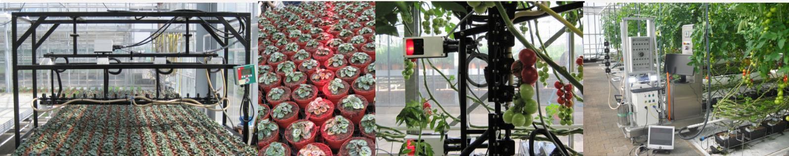
Das Precision Spraying System (PSS) oder Präzisions-spritzsystem ist ein Spritzbaum, der an einem Transportsystem durch das Gewächshaus bewegt wird und nur dort spritzt, wo es notwendig ist. Es erkennt mittels eines Sensors, ob die Kultur möglicherweise eine krankhafte Stelle aufweist und spritzt lediglich an diesen Stellen. Das Spritzen kann dann abhängig von der Pflanzengröße und -dichte durchgeführt werden.
