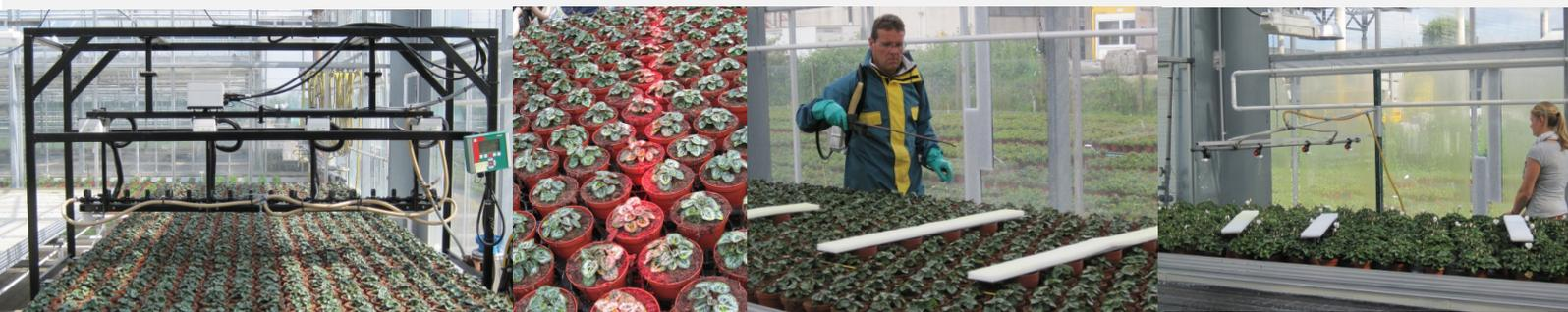
Crop Adapted Spraying (CAS) oder PFLANZENANGEPASSTES Spritzsystem spritzt nur da, wo es nötig ist. Mittels eines Sensors wird ermittelt, ob dort eine Pflanze steht, wie groß und wie dicht die Pflanze ist und es wird nur dort gespritzt, wenn nötig.
